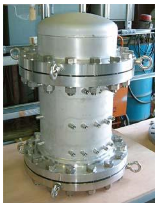
図10. 製作した水素吸蔵合金タンクの外形写真と機器仕様
