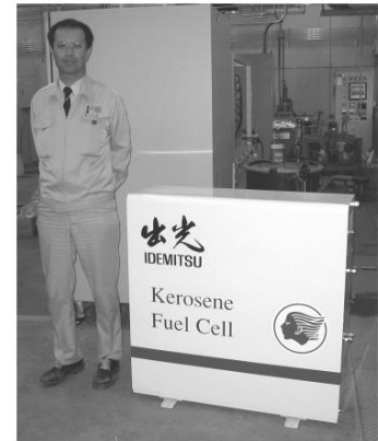
図 9. 灯油改質器と灯油型家庭用燃料電池システム (自社製1号機)
