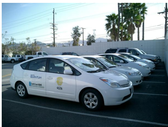
図4. Burbank市の水素エンジン改造プリウス
