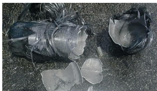
図12 破裂試験結果
