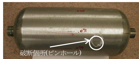
図5 破断の様子2 (6069-T6)
