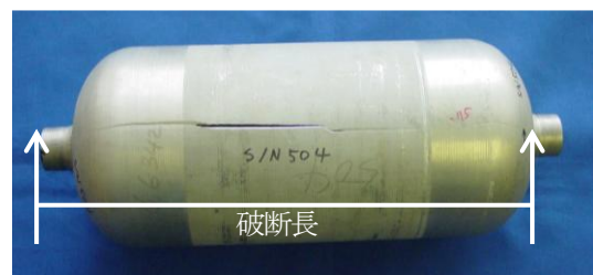
図6 破断の様子3 (7075-T73)
