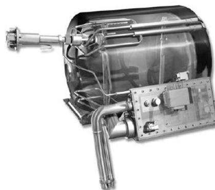
図9. 車載液体水素タンク
