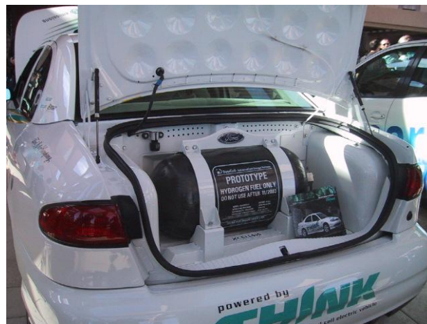
図-2 : 車載用高圧水素容器
