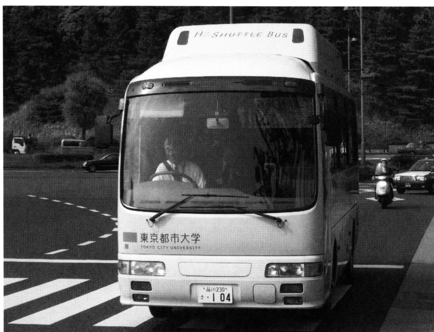
図8 白ナンバープレートを付けて公道を走行する東京都市大学内燃機関水素バス
