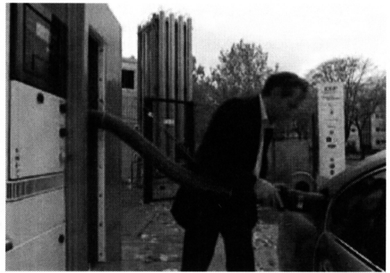
図3. ドイツで設置された液体水素セルフ充填スタンドでBMW水素エンジン自動車に液体水素を充填している写真
