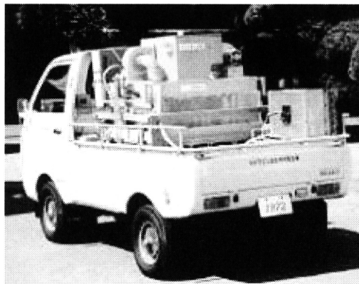
図8. アルカリ形燃料電池車：産総研1972年製
