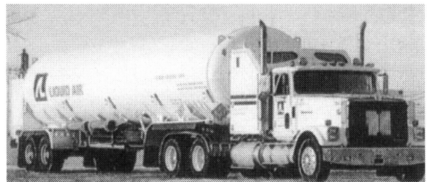
写真7. 米国最大の液体水素タンクローリ[71]
